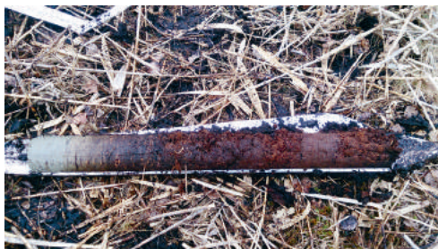
13. attēls. Augsnes zondējums. Foto: I. Bebre.
