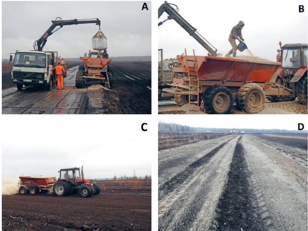
137. attēls. Koksnes pelnu kļiedēšanas process: A – koksnes pelnu transportēšana un iekraušana; B – koksnes pelnu mitrināšana; C – koksnes pelnu kļiedēšana; D – izkļiedītie pelni pirms iestrādes augsnē. Foto: G. Spalva.
