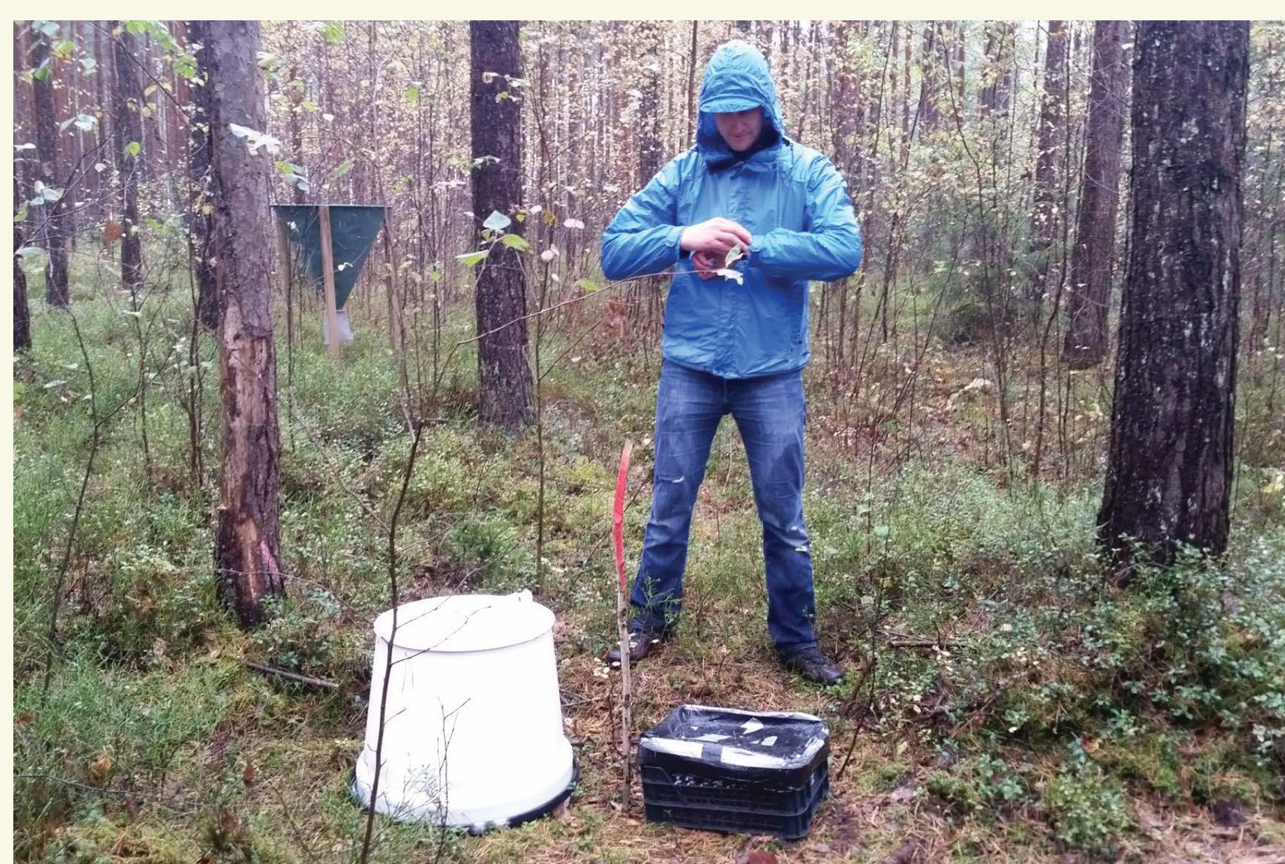
SEG emisiju mērījumi tiek veikti kūdrājos visā Latvijā ar slēgto kambaru metodi
