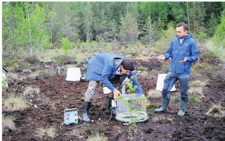
▲ JAU otro gadu Dabas aizsardzības pārvaldes un Eiropas Savienības LIFE programmas projekta LIFE REstore ietvaros tiek veikti SEG emisiju mērījumi dažāda veida kūdrājos 42 vietās Latvijā.
